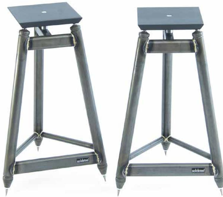
gespreizt. Horizontal wird der Ständer oben und unten durch schlankere Stahlrohre ausgesteift. Verbunden sind die Rohre durch sauber ausgeführte Hartverlötungen. Insgesamt entsteht so eine sehr solide Konstruktion, die in ihrer Konsequenz an modernen Stahlbau erinnert.
